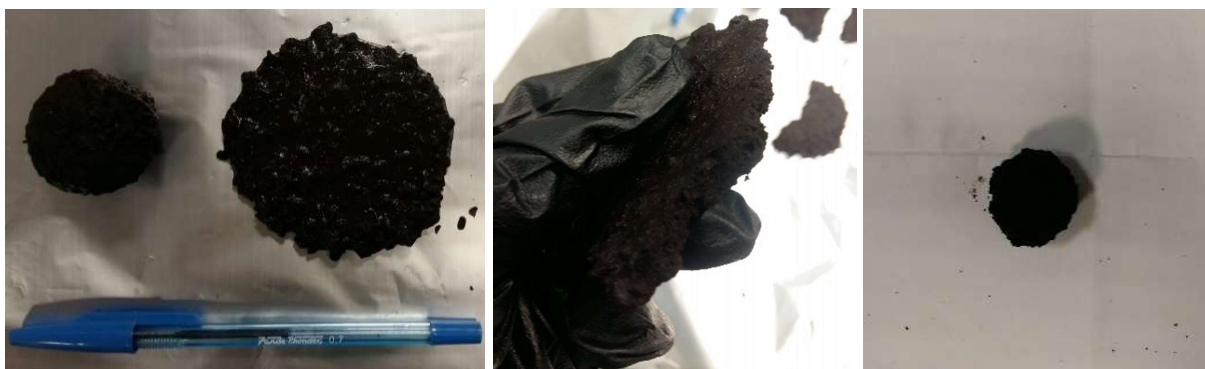
Fig. 4: Amostras preparadas com a emulsão C65BP4_IT antes e depois dos testes da pizza e da bola.
