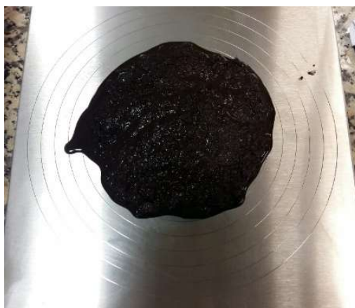
Fig. 6: Resultado do ensaio de consistência da mistura preparada com a emulsão C60BP4_IT.
