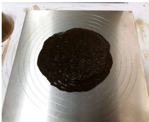
Fig. 5: Resultado do ensaio de consistência da mistura preparada com a emulsão C65BP4_IT.
