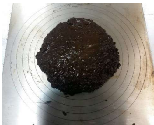
Fig. 7: Resultado do ensaio de consistência da mistura preparada com a emulsão C60BP4_PT.
