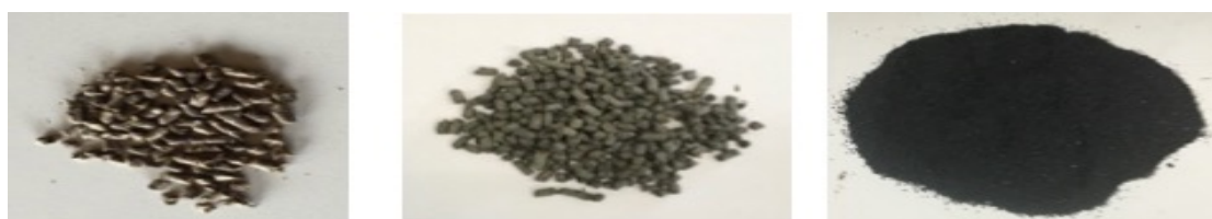
Figura 3 – Aditivos usados nas misturas betuminosas SMA: a) Fibras de celulose Viatop Premium; b) Fibras de celulose revestidas com borracha Viatop Plus FEP; c) Borracha
