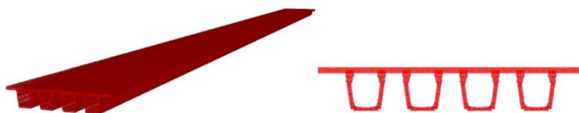
Figura 13 – Modelo de elementos finitos da ponte.
