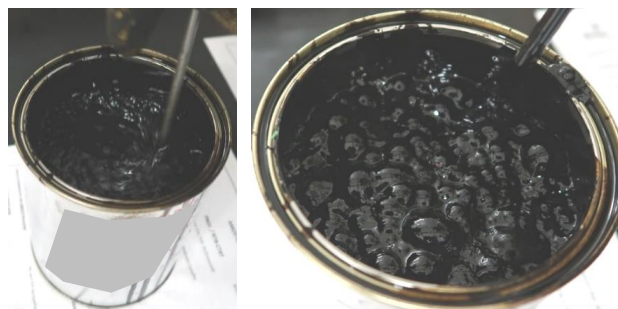
Fig. 2. Efervescência decorrente da adição e mistura do aditivo B2P3 ao betume
