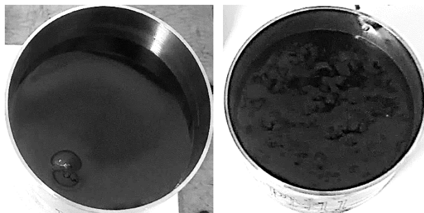
Fig. 1. Betume homogéneo (esquerda, B2P4) e heterogéneo (direita, B2P2)
