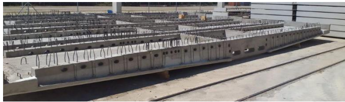
Figura 10. Placa pré-fabricada tipo bidirecional (fonte: Alvipre Factory S.L.)
