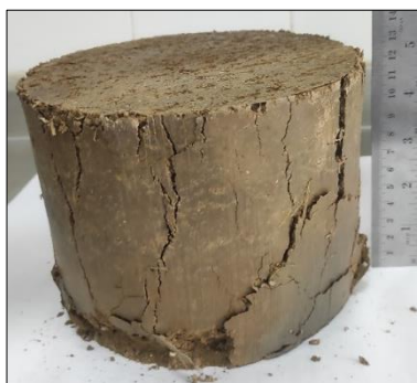
Fig. 6 . Provete após ensaio de compressão uniaxial
