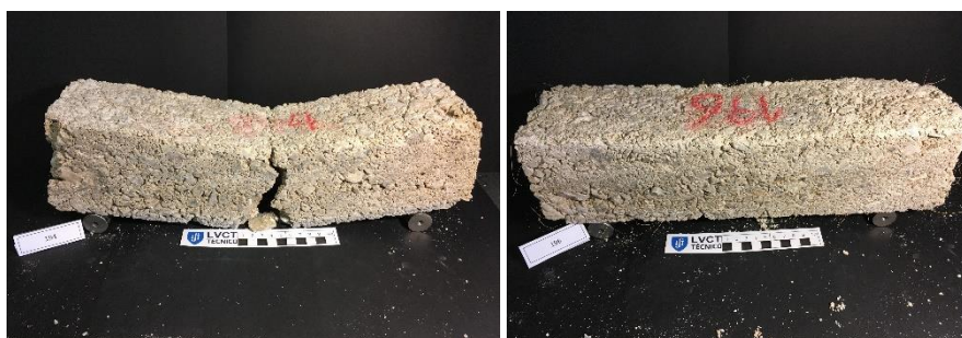
Fig.5. Exemplo de provetes de MTC com AN e 2% cimento, sem FC (esquerda) e com FC (direita), após o ensaio de resistência à flexão
