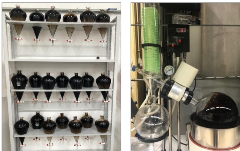
Fig.1. Etapas da produção do bio-óleo pesado: extração (esquerda); destilação (direita)
