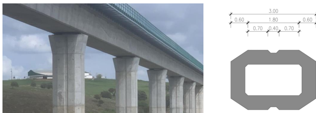
Fig. 5: Geometria dos pilares
