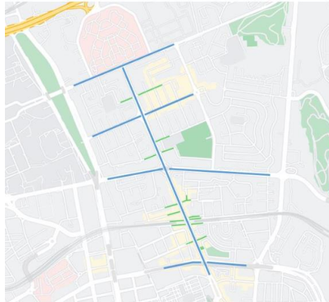
Fig. 3. Rede viária do caso de estudo: nível hierárquico 3 (azul); níveis hierárquicos 4 e 5 (verde). Base Google Maps.
