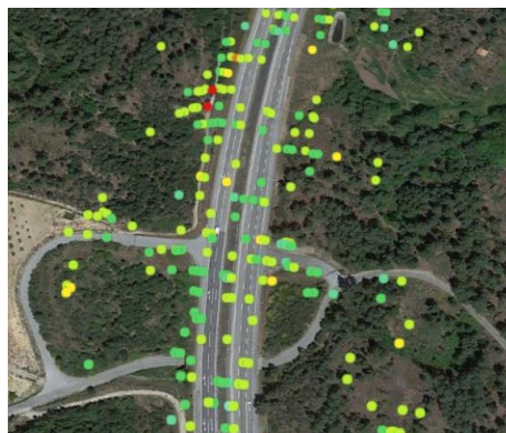
Fig. 1. Técnica SBAS aplicada à A24, com zonas de subsidência grave representadas por pontos a vermelho
