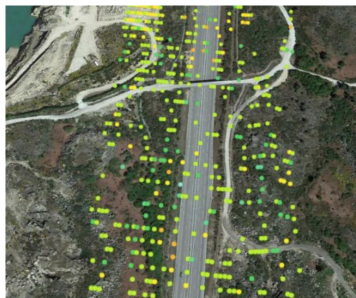
Fig. 3. Exemplo da densidade de pontos de medição possíveis através da técnica de SBAS
