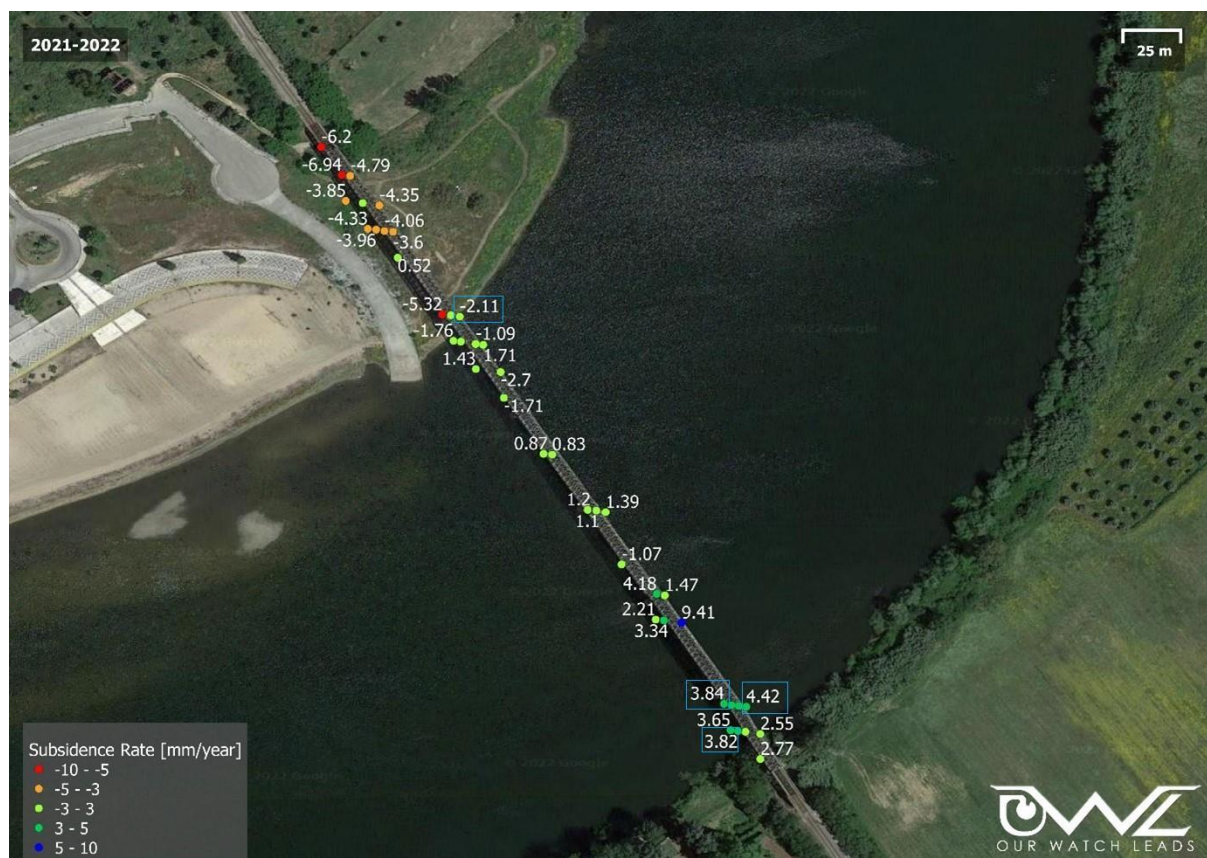
Fig.4. Deslocamentos na ponte ferroviária do Tejo da linha da Beira Baixa
