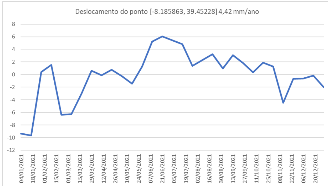
Fig.5. Gráfico de deslocamentos do ponto com velocidade anual de +4,42mm por ano em 2021
