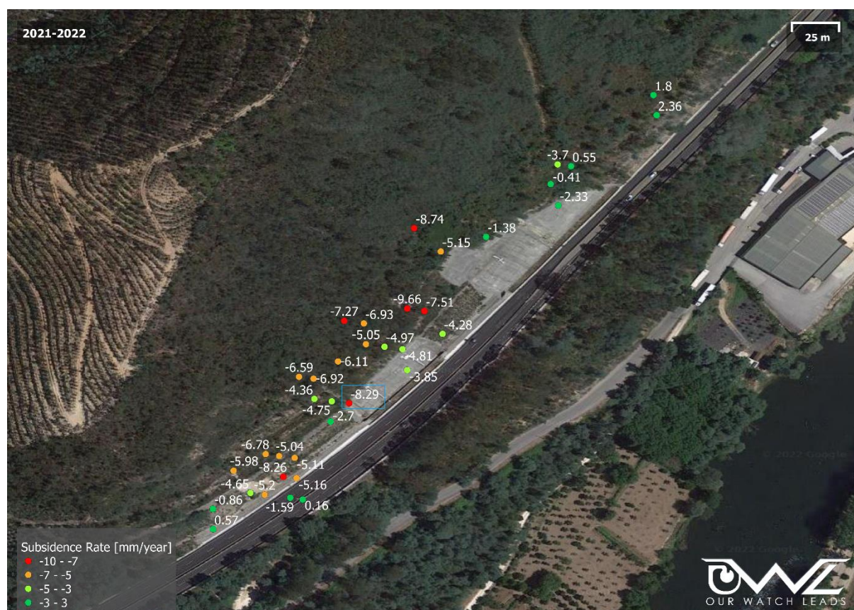
Fig.1. Deslocamentos na encosta adjacente ao IP3
